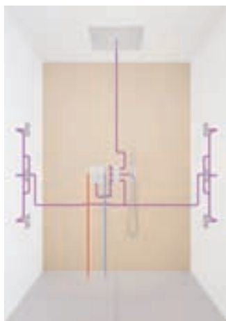
Centrální sprchová baterie s trojcestnými podomítkovými ventily Grotherm F
