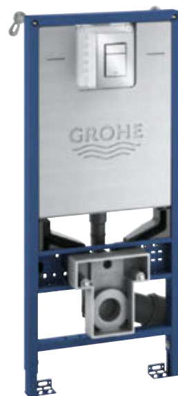
39 603 000 Rapid SLX WC 3-6 | 1,13 m s nástěnnými držáky a tlačítkem Skate Cosmopolitan S, chrom Instalační rám Rapid SLX pro WC, výška instalace 1,13 m se splachovací nádrží GD2, včetně elektrické zásuvky, s regulátorem průtoku, snadný přístup a kompletní izolace od kondenzující vody. Včetně nástěnných držáků a splachovacího tlačítka Skate Cosmopolitan S (chrom).
