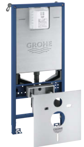
39 598 000 Rapid SLX 3 v 1 WC 6 | 1,13 m s nástěnnými držáky a protihlukovou izolací Instalační rám Rapid SLX pro WC, výška instalace 1,13 m se splachovací nádrží GD2, včetně elektrické zásuvky, s regulátorem průtoku, snadný přístup a kompletní izolace od kondenzující vody. Včetně nástěnných držáků a protihlukové izolace.
