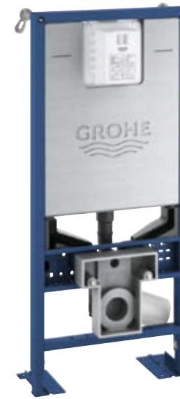
39 599 000 Rapid SLX WC 3-6 | 1,13 m F, vysokozátěžová varianta Instalační rám Rapid SLX pro WC, výška instalace 1,13 m se splachovací nádrží GD2, včetně elektrické zásuvky, s regulátorem průtoku, snadný přístup a kompletní izolace od kondenzující vody. Vysokozátěžová varianta s posílenými opěrnými nožičkami.
