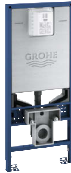
39 597 000 Rapid SLX WC 3-6 | 1,13 m, bez odtokové trubky Instalační rám Rapid SLX pro WC, výška instalace 1,13 m se splachovací nádrží GD2, včetně elektrické zásuvky, s regulátorem průtoku, snadný přístup a kompletní izolace od kondenzující vody. Bez odtokové trubky.
