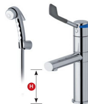
MR 67178 CR monocomando lavabo alto, h.110 mm, leva lunga mobilità ridotta, bocca girevole, doccetta laterale multiuso single-lever high basin mixer, h.110 mm, easy-to-use long lever, swivel spout, multipurpose handset
